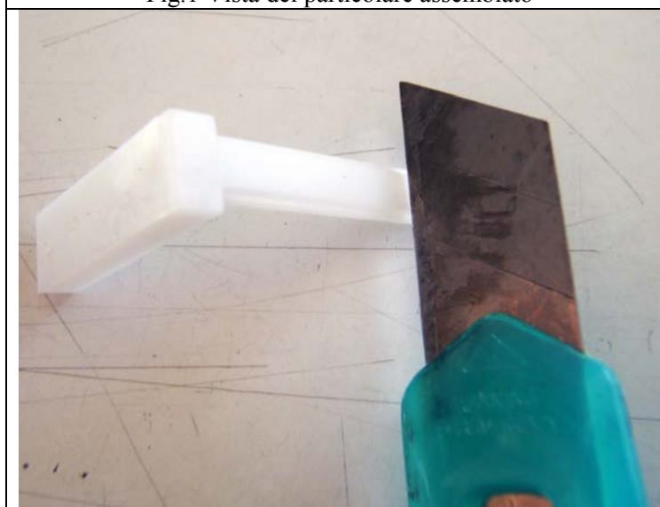
Fig.3 Taglio a misura delle alette
